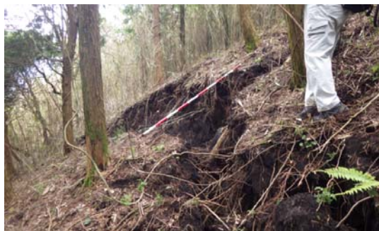
阿曾大橋付近の大規模な斜面崩壊の周辺の斜面上の亀裂（H28.4.23撮影）
